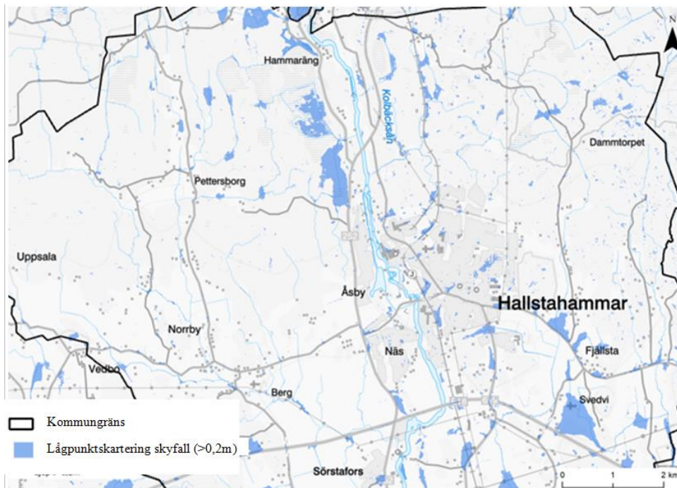
Figur 15. Områden med vattendjup på >0,2 m vatten vid en skyfallshändelse. Norra delen av Hallstahammars kommun.
